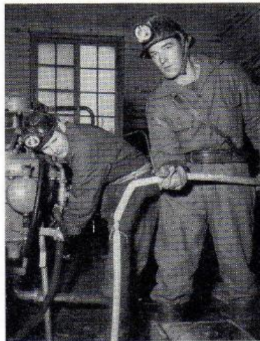
Vid försöken i Kristineberg patronerade bergsingenjör Hans Hamrin AN med hjälp av laddningsaggregat (bilden i mitten). I gruvan mätte Hamrin patronernas längd innan borrarern Erland Jonsson (längst till vänster) laddade salvan.
