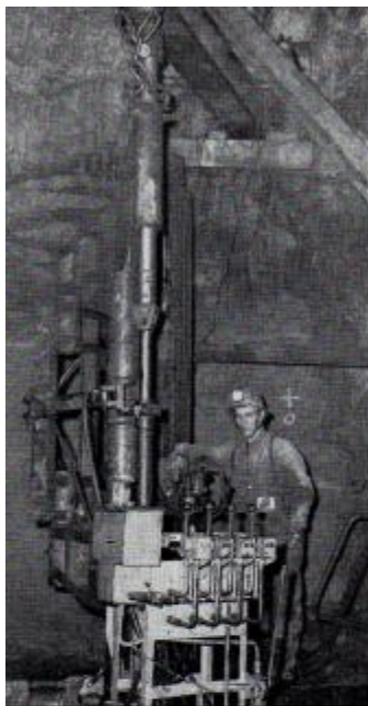
Borräggregatet BUB 11 uppställt för stigortsdrivning i en av våra gruvor. Nedan: Diagram över krav på noggrannhet vid långhålsborrning av stigheter.
